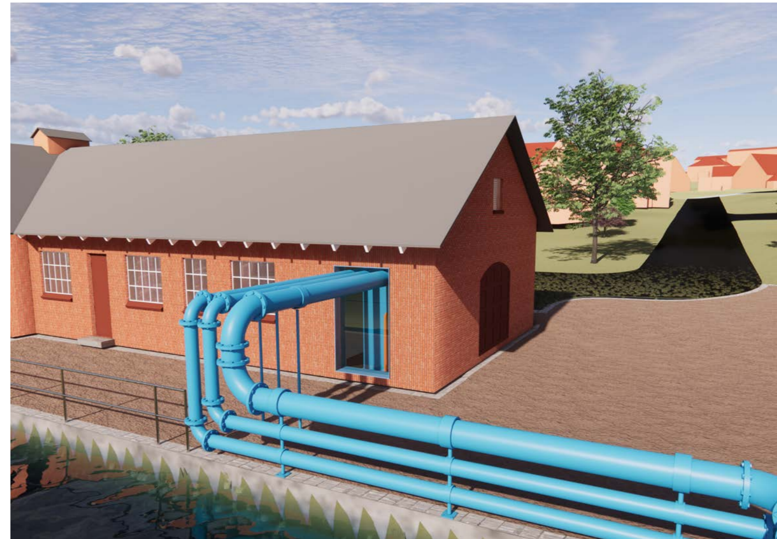
EKSEMPEL PÅ ÅBNING MED INDSKUDT "KASSE" I EKSISTERENDE FACADE
